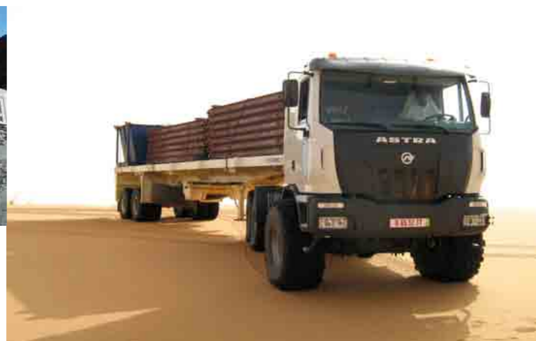
6x6 Trattore versione deserto con pneumatici sabbia 24.00 R20.5 6x6 Tractor, desert version with sand tyres 24.00 R 20.5
